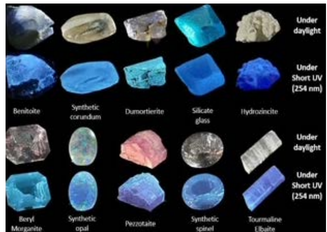
Figure 1 : Echantillons étudiés en lumière naturelle et sous ultraviolets courts, émettant une luminescence bleue due au groupement titanate
