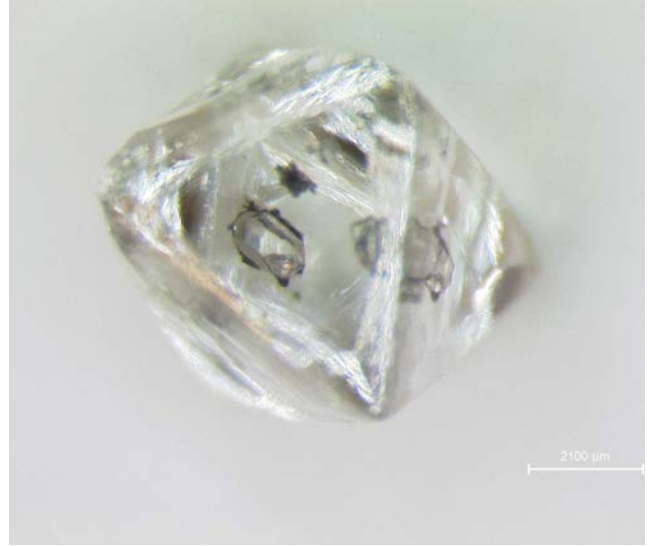
Figure 2 : Diamant monocristallin octaédrique (dimensions 5 x 5 mm) alluvial de Santa Helena au Venezuela, renfermant une inclusion minérale d'olivine en son cœur. L'olivine est le minéral principal du manteau supérieur. Collection des Minéraux de Sorbonne Université
